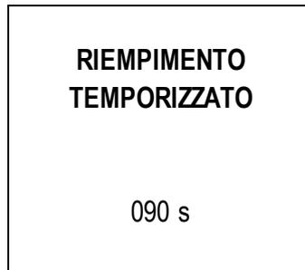
SOLO NEL RIEMPIMENTO MANUALE: il valore indica infatti i secondi in cui rimane attivata la pompa per il riempimento dell'acqua pulita. Per variare i valori agire su freccia su/giù.
